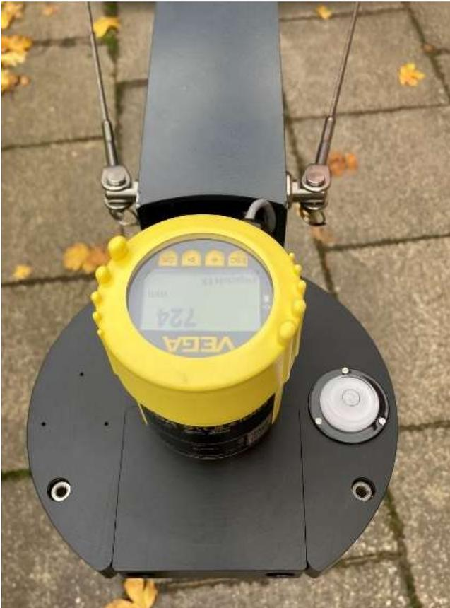
Figure 38. Le capteur radar et le niveau à bulle.
