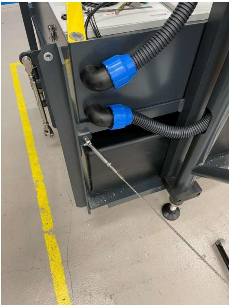
Figure 12. Le câble de haubanage fixé à la monture principale avec réglage du ridoir.
