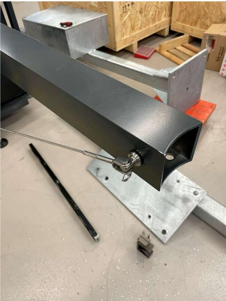
Figure 11. Les câbles de haubanage attachés au bras radar.
