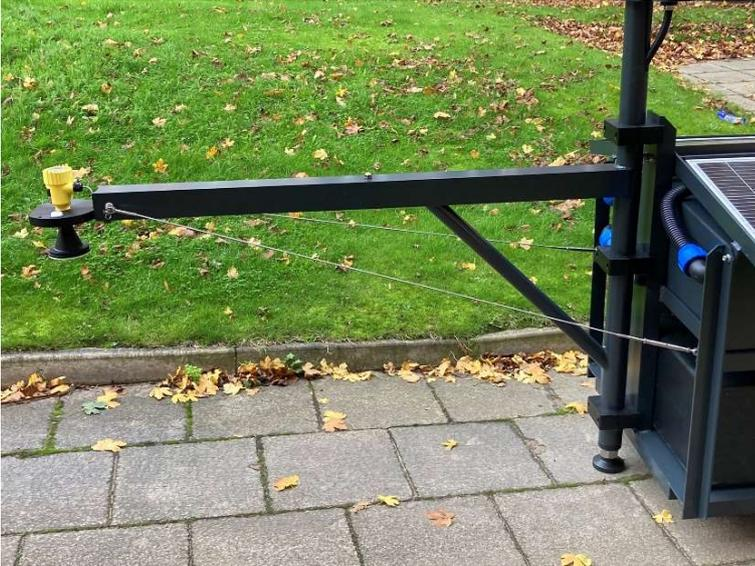
Figure 10. Les câbles (de haubanage) de tension du bras radar.
