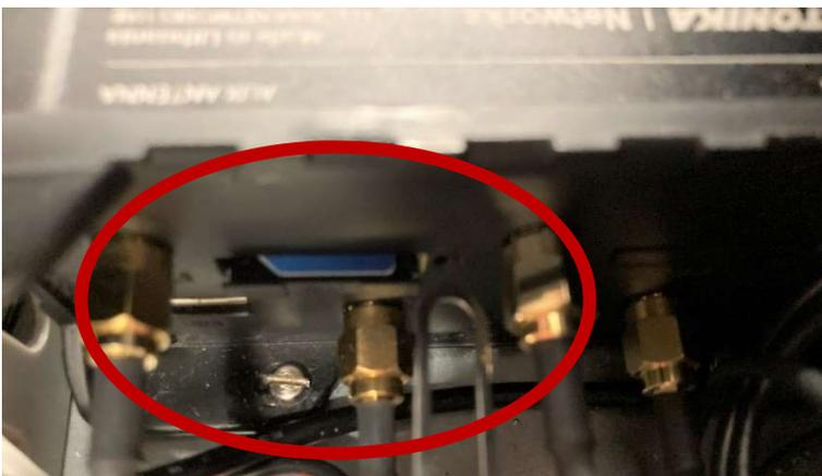
Figure 31. La fente pour carte SIM et pin d'accès.
