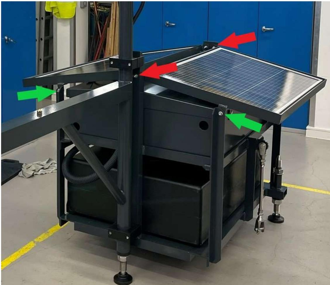
Figure 16. Les emplacements des boulons de montage du panneau solaire. Les flèches vertes indiquent les boulons retirés pour accéder aux boîtiers de l'équipement.
