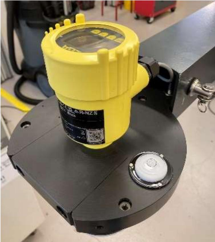
Figure 13. Le capteur radar monté sur le bras radar.
