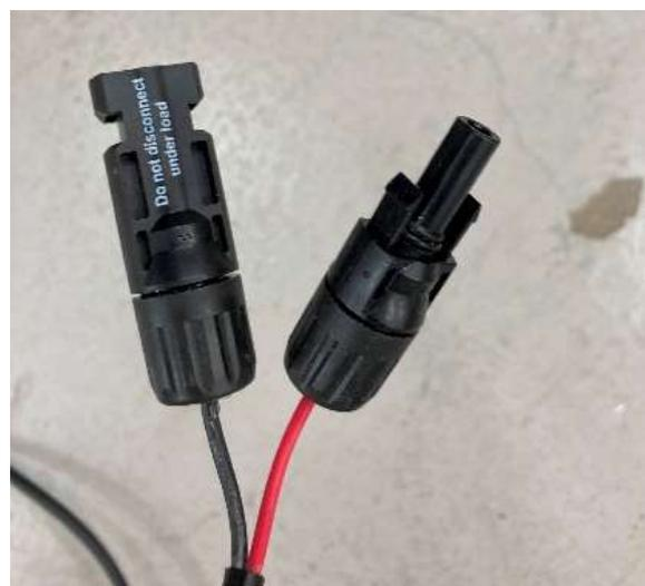
Figure 19. Les connecteurs standard pour panneaux solaires.
