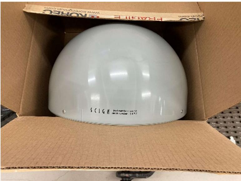
Figure 7. Le radôme d'antenne GNSS.
