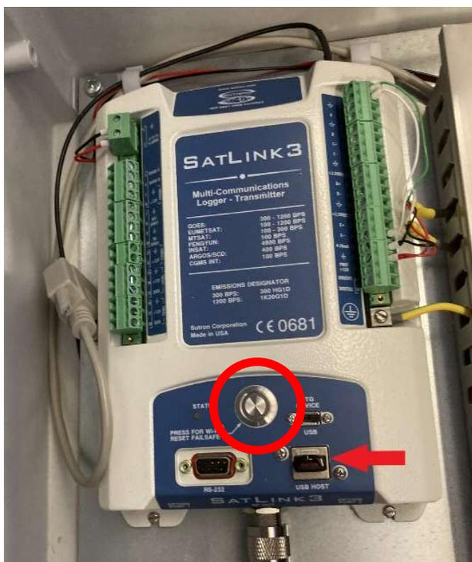
Figure 43. Téléchargement des données de la clé USB (flèche rouge), bouton de connexion Wi-Fi (cercle rouge).
