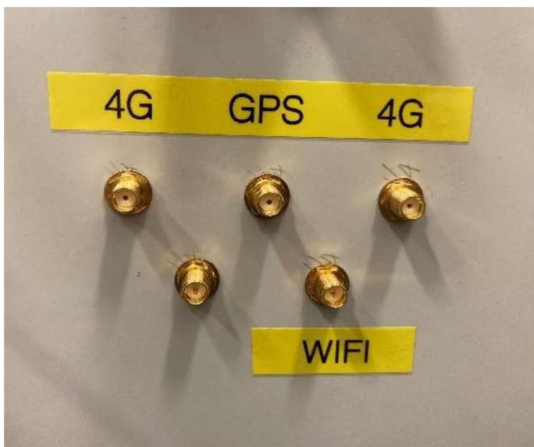
Figure 22. Les connecteurs SMA de communication 4G.
