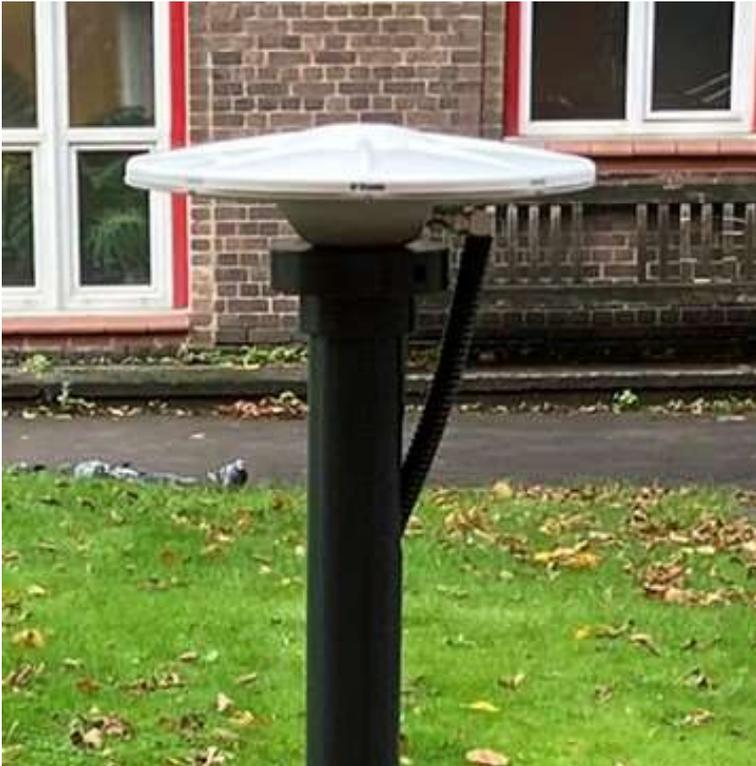
Figure 6. L'antenne GNSS et le câble montés sur le mât.
