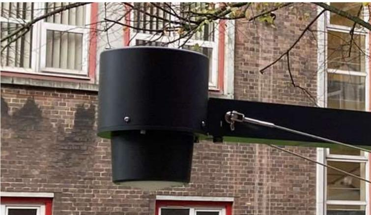
Figure 40. Le capteur radar avec capot de protection.
