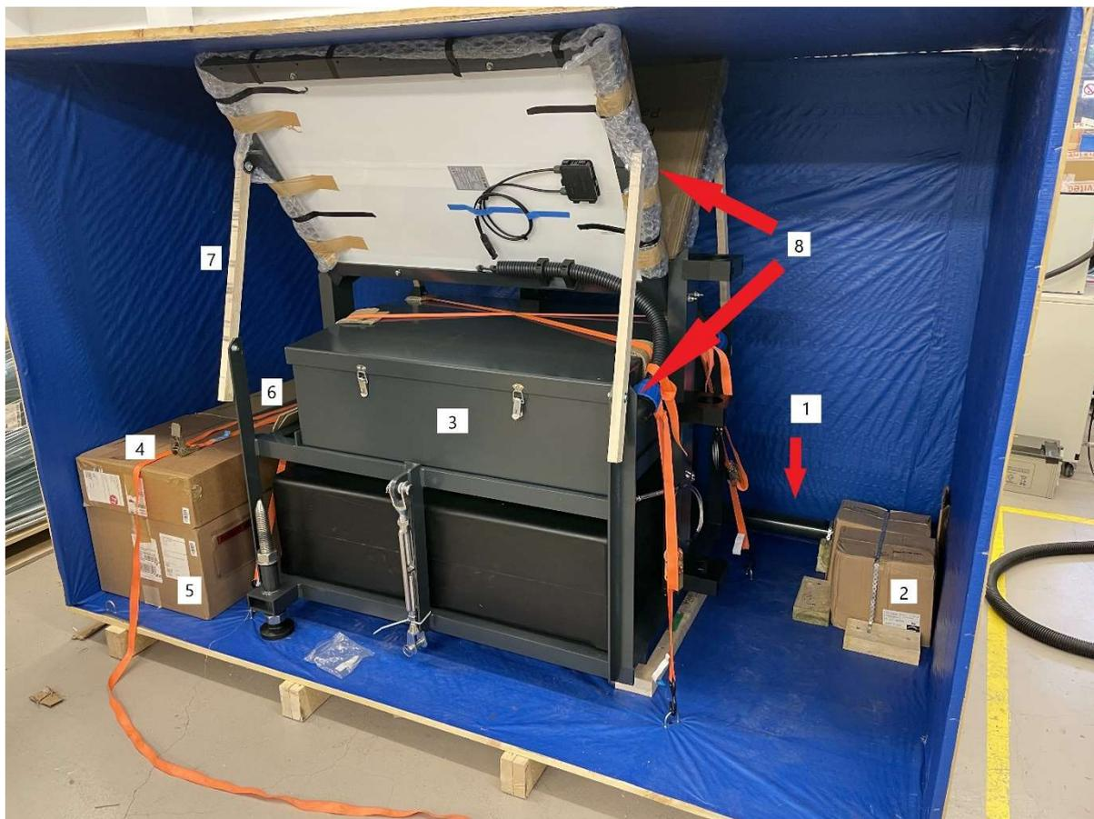
Figure 4. La Portagaugue partiellement démontée pour le transport maritime.
